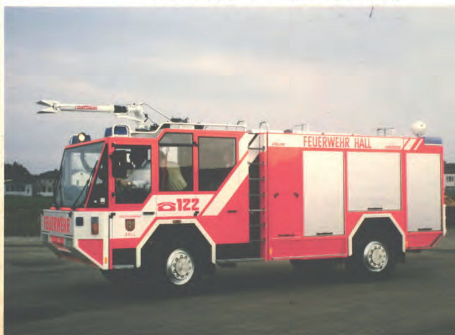
DAS ERSEHNTNE NEUE Tanklöschfahrzeug steht nun im Gerätehaus der Freiwilligen Feuerwehr Hall. Die Haller verfügen mit dem TLFA 3700/300 über das modernste Fahrzeug, das derzeit in Österreich erhältlich ist. Der Wagen faßt 3700 Liter Wasser und 300 Liter Schaum. Foto: Garber
