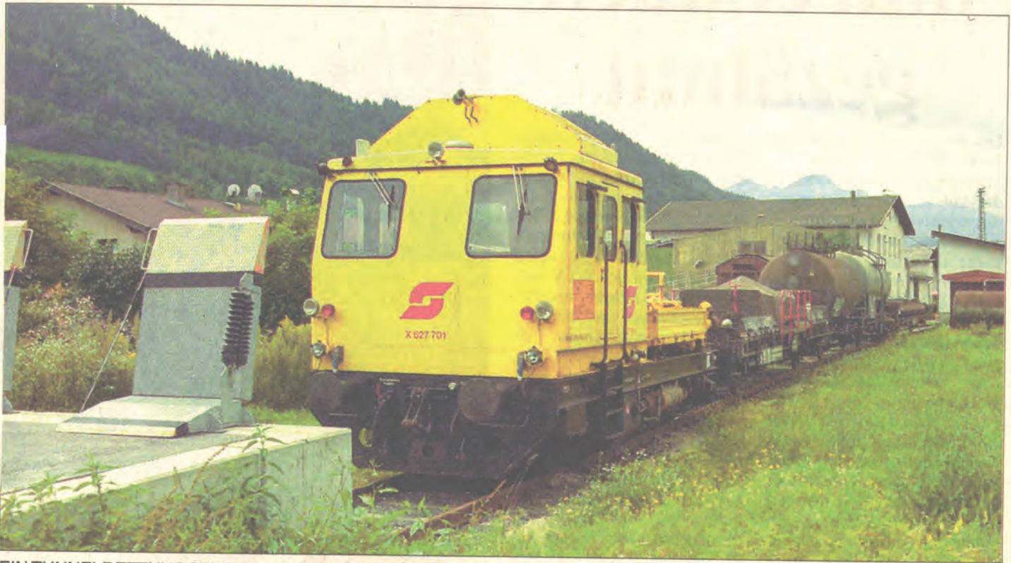
EIN TUNNELRETTUNGSZUG: Zwischen den Wasserwaggons und der Lok wird das Feuerwehrfahrzeug aufgeladen. TT-Foto: Parigger
